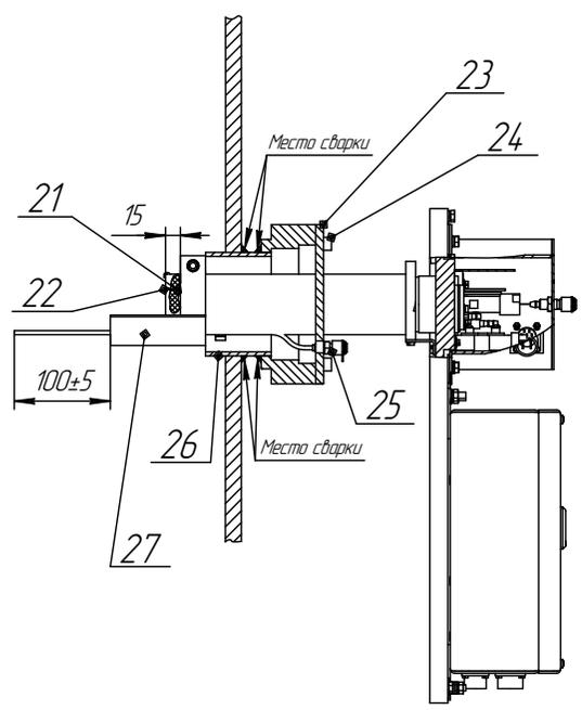
Монтаж газоанализатора в кирпичную стену газохода
