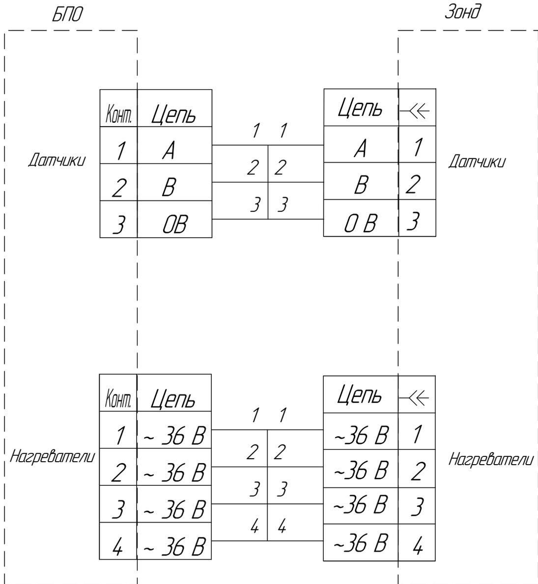
Рисунок 2.1 – Схема электрическая соединений БПО с зондом
