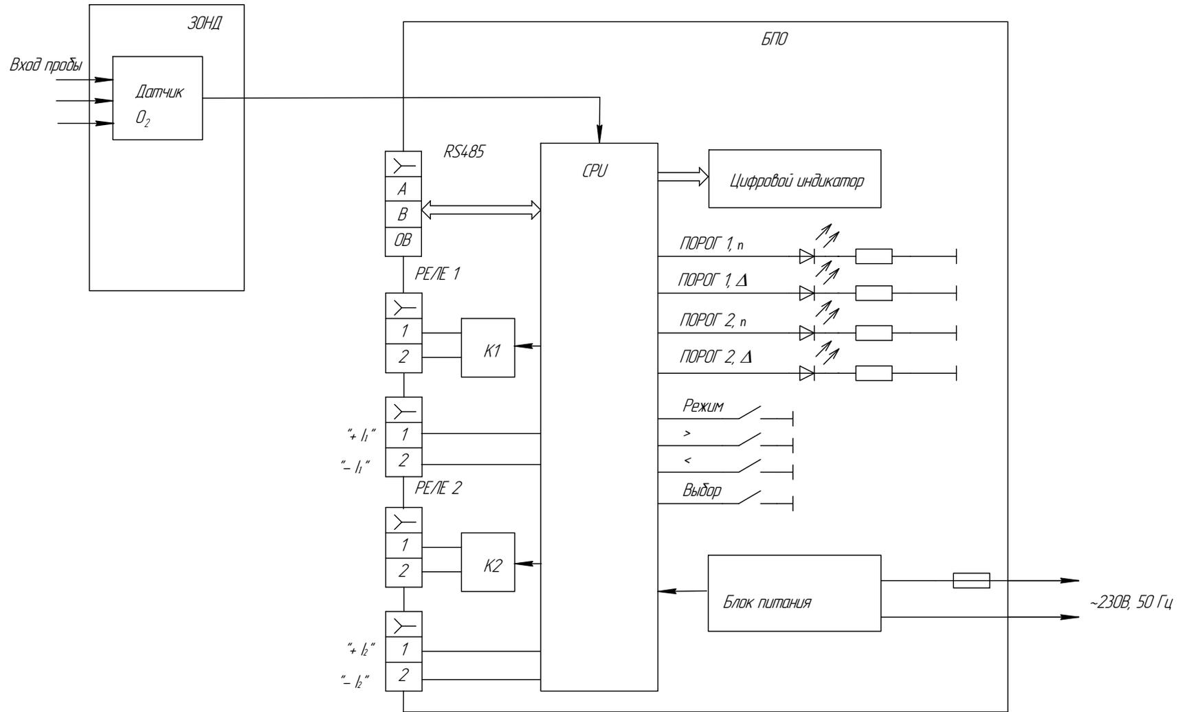
Рисунок 1.2 - Газоанализаторы АКВТ-01. Схема функциональная
