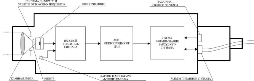
Рис.3. Структурная схема прибора.
