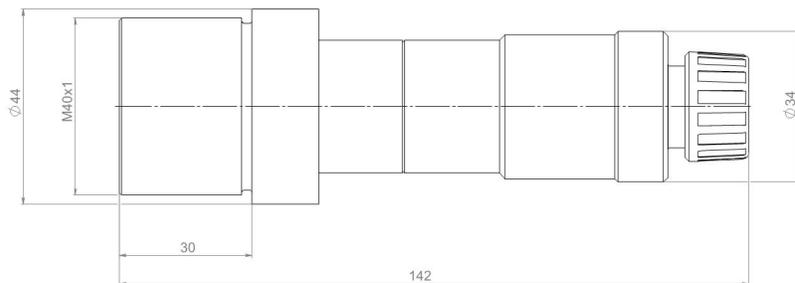
Рис.14. Визир оптический прямой
