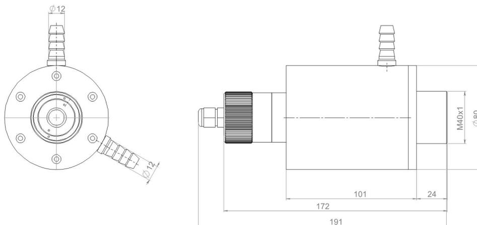
Рис. 2б. Габаритные размеры пирометра с водо/воздухоохлаждаемым кожухом
