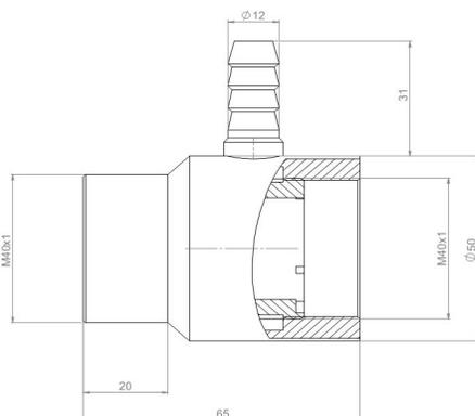
Рис.6. Воздуходувная насадка
