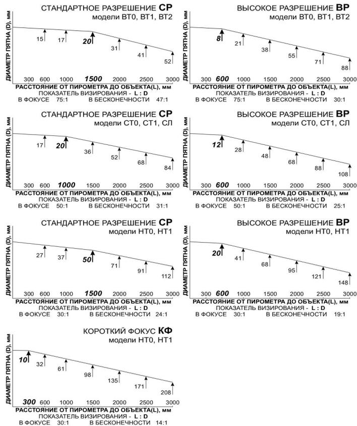
Рис.4. Оптические характеристики.
