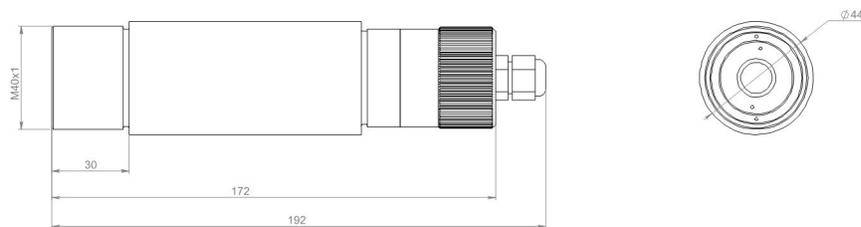
Рис. 2а. Габаритные размеры пирометра
