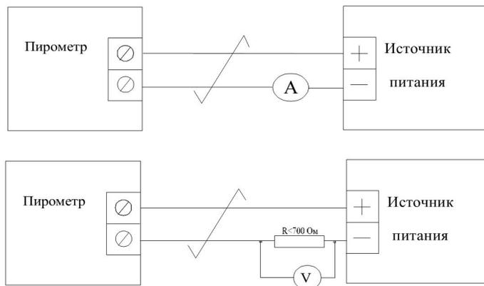
Рис. 16. Схема подключения.
