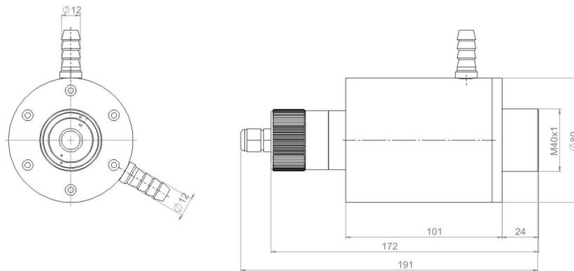
Рис. 11. Водо/воздухоохлаждаемый кожух
