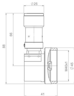
Рис.13. Визир оптический угловой
